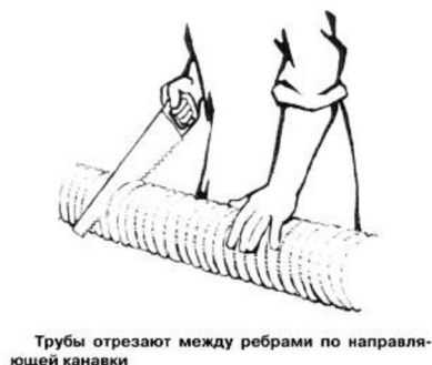
а) резка труб ножовкой
