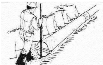
г) опрессовка (перемещение) трубы посредством лебедки
