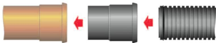
Рисунок 16. Соединение труб ПЕРФОКОР с трубами из ПП/ПВХ
